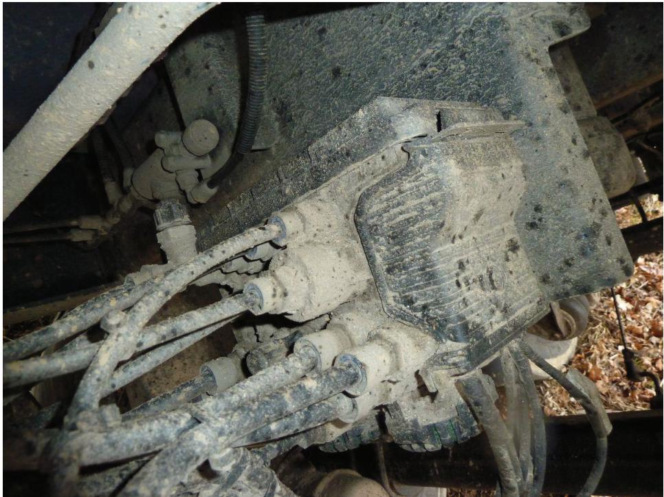
Obr. 5-20 – Pohled na modulátor TEBS umístěný na přípojném vozidle (zdroj: archiv autora)
