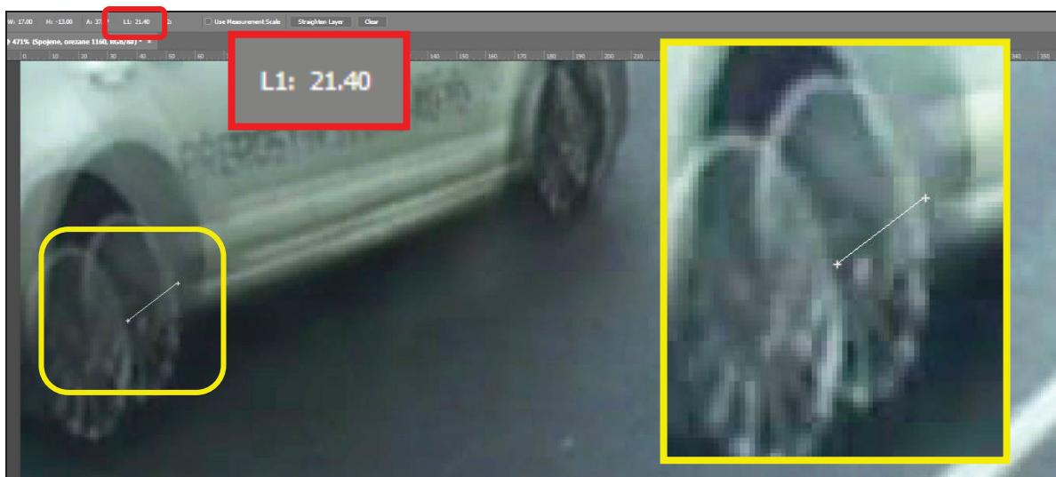
Obr. 7-26 – Odměřené posunutí disku kola mezi snímky 1159 a 1160
