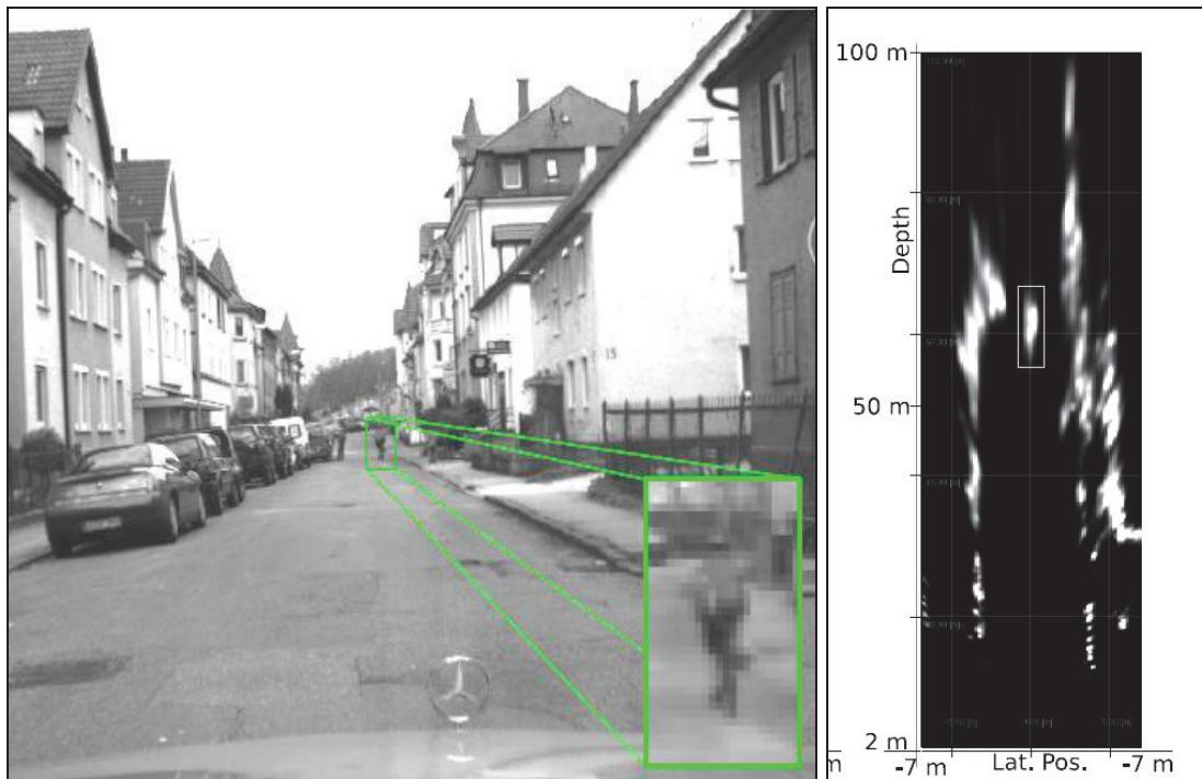
Obr. 10-18 – Prevod obrazu do karteziánskeho súradnicového systému [6]
