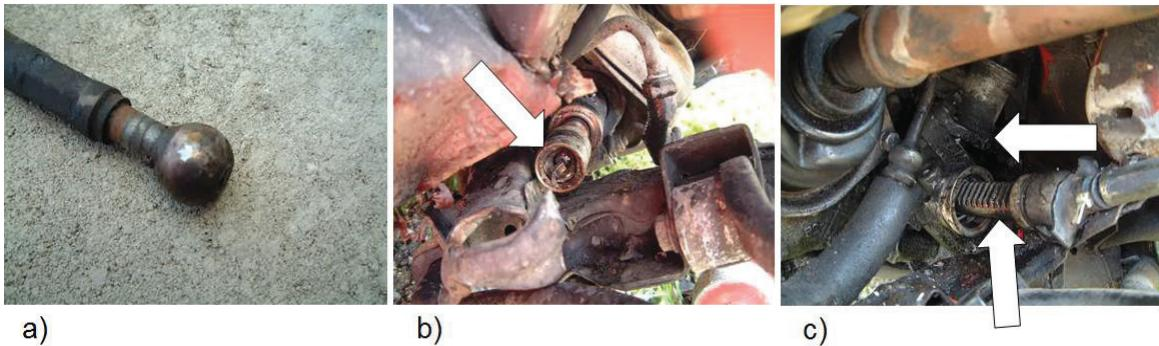
**Obr. 1-33 – Snímky z technického šetření vozidla Renault – a) pravá řídicí tyč oddělená od konce hřebene řízení; b) konec hřebene řízení na pravé straně bez řídicí tyče; c) destrukcí a deformacemi poškozená druhá levá strana převodky řízení hřebene [16]**
