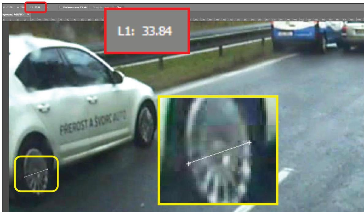
Obr. 7-25 – Odměřená velikost disku kola v pixelech na snímku č. 1160
