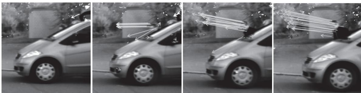
**Obr. 10-20 – Príklad trakovania pohybu chodca pomocou stereokamery [6]**
